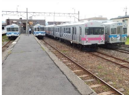
黒石駅に集まる弘南線の電車（大鰐線の電車も同型）。30年ほど前まで東急電鉄で走っていたステンレス製の車両で、冷房は付いていません。
